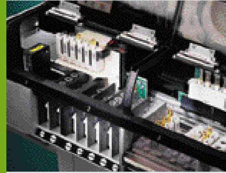
RSH Öncelikli Bölmeleri, 2 dakikadan daha az süre içerisinde STAT numune tüpüne erişime imkanı sağlar
