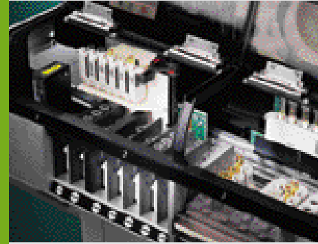
RSH Öncelikli Bölmeleri, 2 dakikadan daha az süre içinde STAT numune tüpüne erişme imkanı sağlar.
